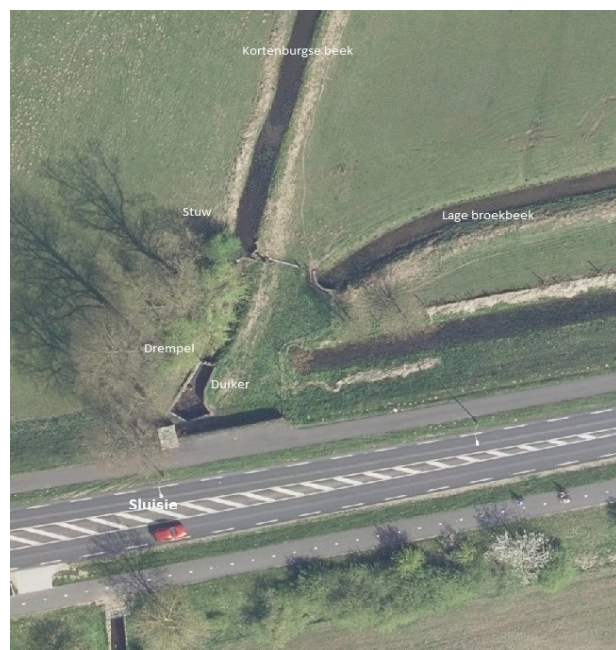
Figuur 11: Bovenaanzicht gemaal en N225.
