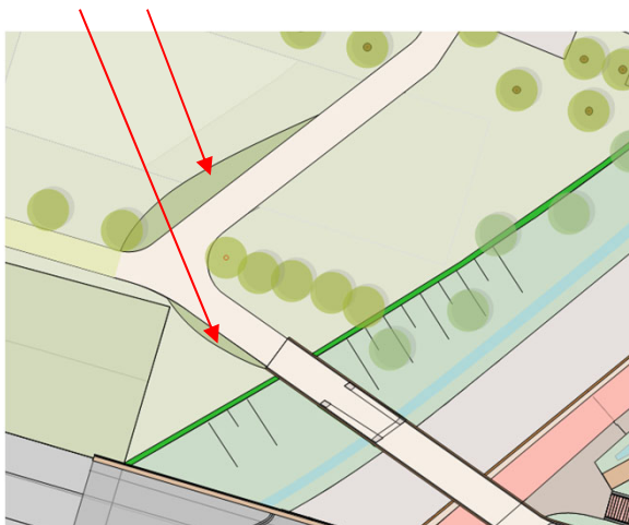
Uitwijkzones in grasbetonstenen
