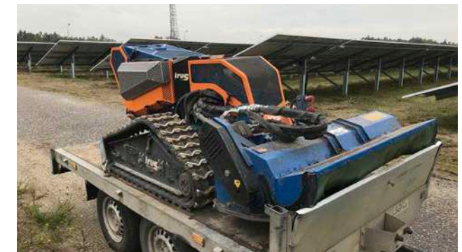
AFSTANDSBESTUURBARE MAAIER: ONDER HOGE HELFT PANELEN
