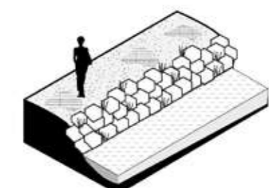
gestapelde stenen benadrukken vormgeving beekprofiel en bieden ruimte voor pioniervegetatie
