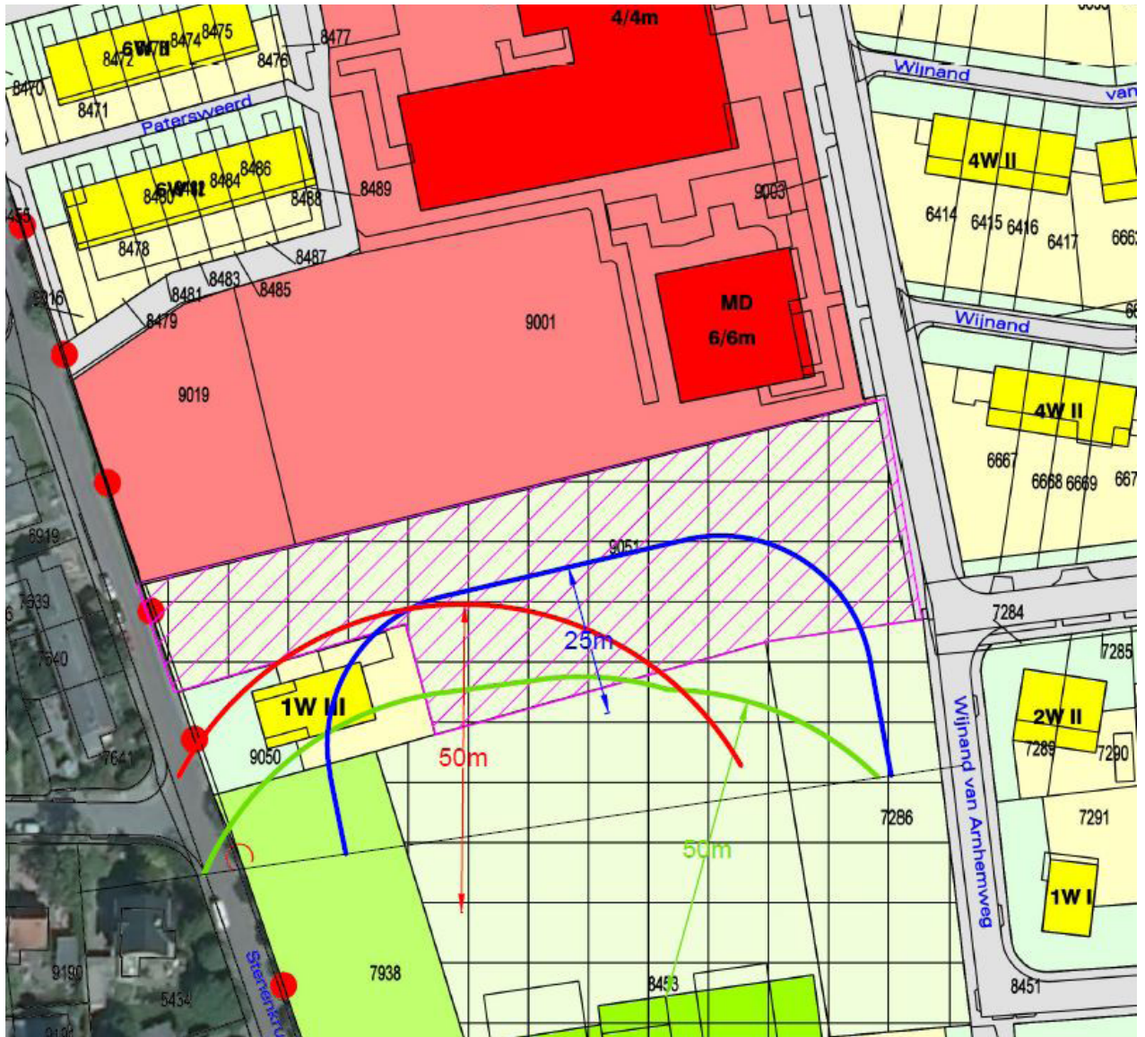
Milieuozonering: de contour van de opslag van kuilvoer is bepalend
