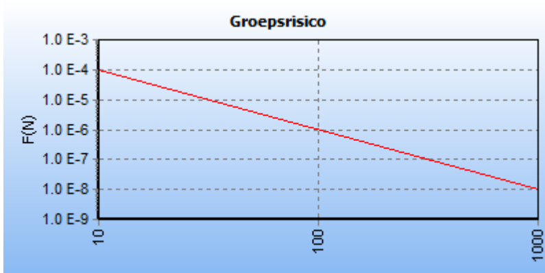
5.5 Figuur 5.5 FN curve voor N-568-30 van N.V. Nederlandse Gasunie voor de kilometer tussen stationing 0.00 en stationing 0.00
