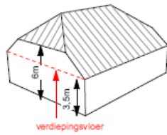
zadeldak met afgesloten topgevels
