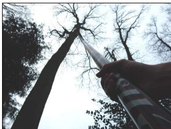
Figuur 11. De holte in de eik is onderzocht door middel van een telescopische endoscoop.
