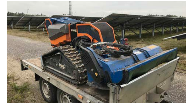
AFSTANDSBESTUURBARE MAAIER: ONDER HOGE HELFT PANELEN
