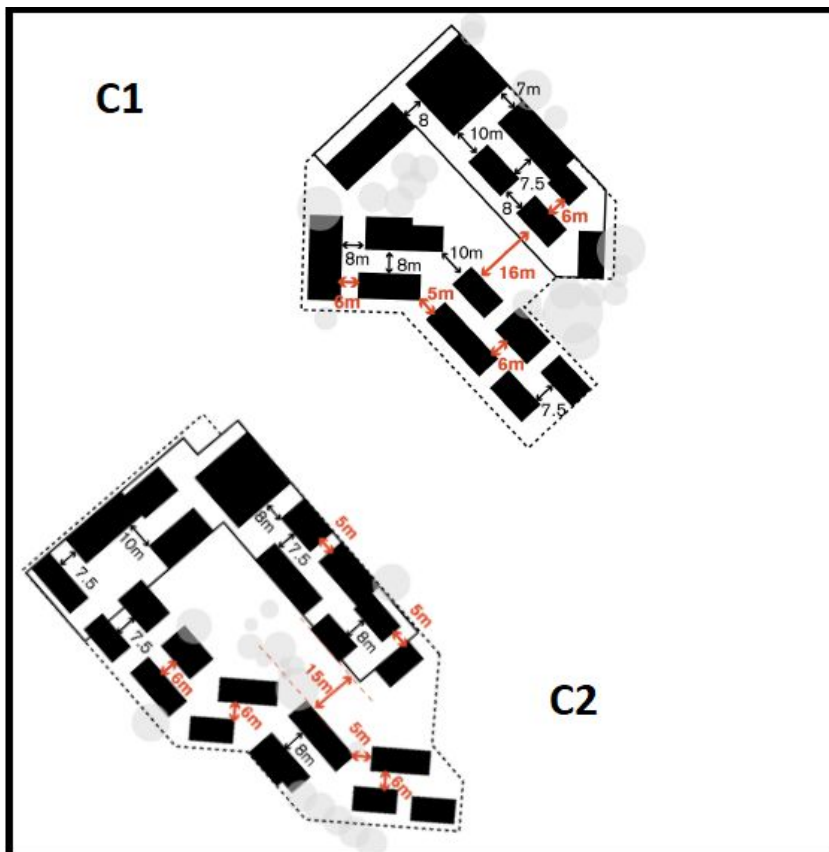
Afbeelding: schets uit Beeldkwaliteitplan Park De Hes. Principes van positionering bouwblokken in bouwvelden C1 en C2 (bron: bureau Zus).
