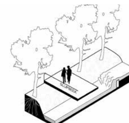
brug is gecombineerd met architectonische stuw en bevat de naam 'Slijpbeek' verwerkt in reling
