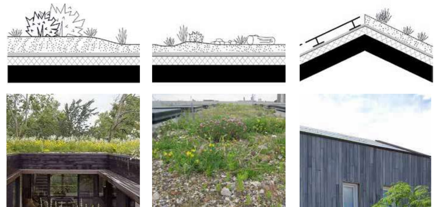
natuurdak opbouw: 150-200mm substraat inheems graskruidentmengsel bij toepassing heesters plaatselijke ophoging tot 400mm
