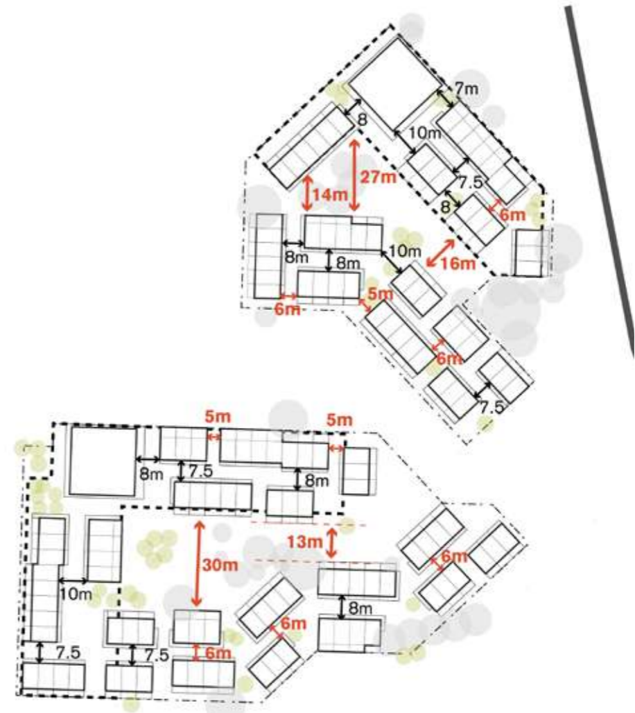
De minimale afmetingen tussen de bouwblokken zijn los van stedenbouwkundige compositie ook gebaseerd op verkeerskundige maatvoeringen. Daarnaast spelen doorzichten en praktisch ruimtegebruik van collectief terrein ook een rol.
