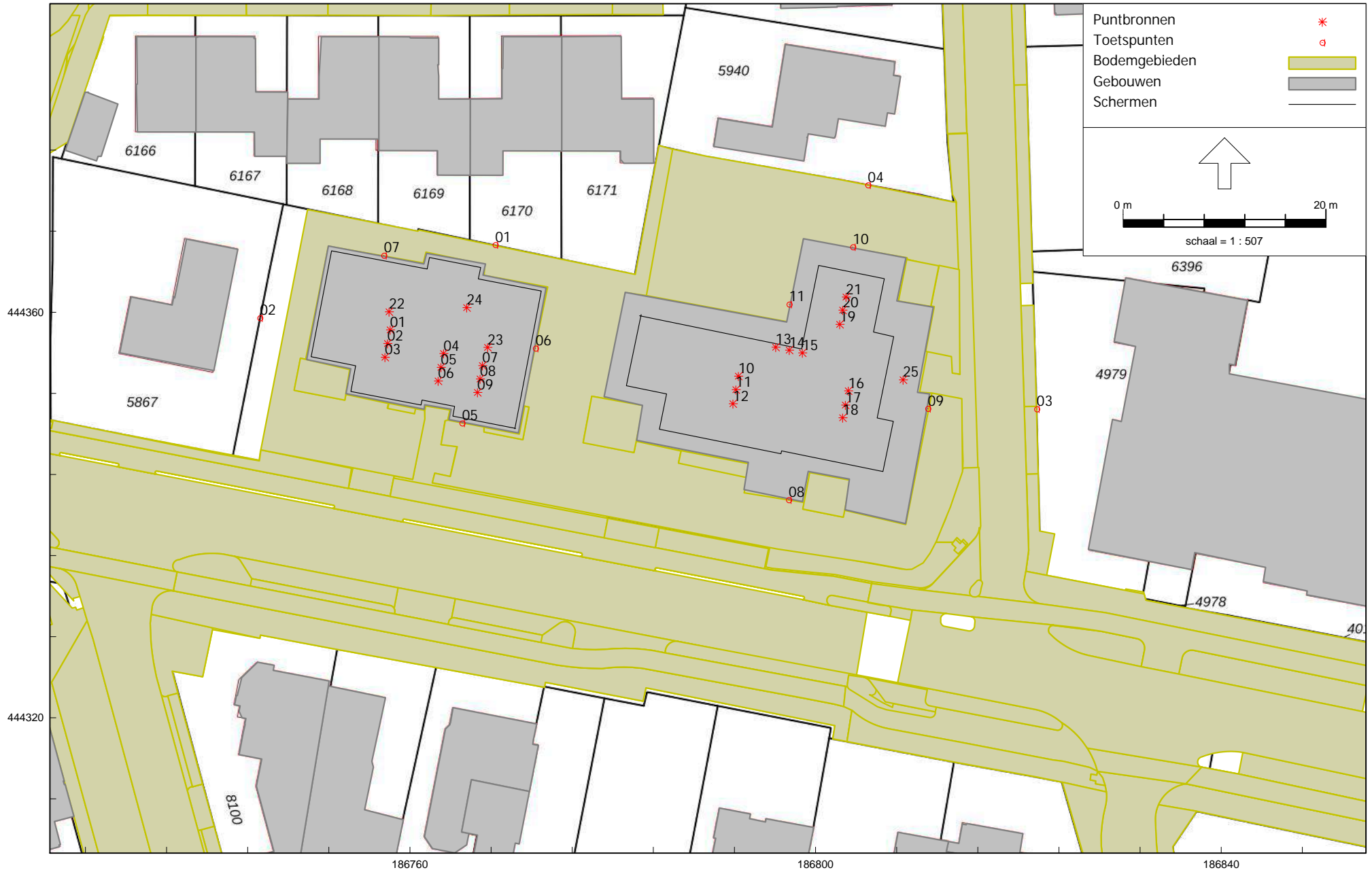
Overzicht van het rekenmodel met de ligging van de ingevoerde objecten, geluidbronnen en rekenpunten
