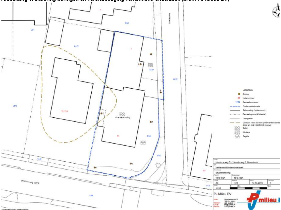
Afbeelding 1: situering boringen en verontreiniging verkennend onderzoek (bron: PJ Milieu BV)
