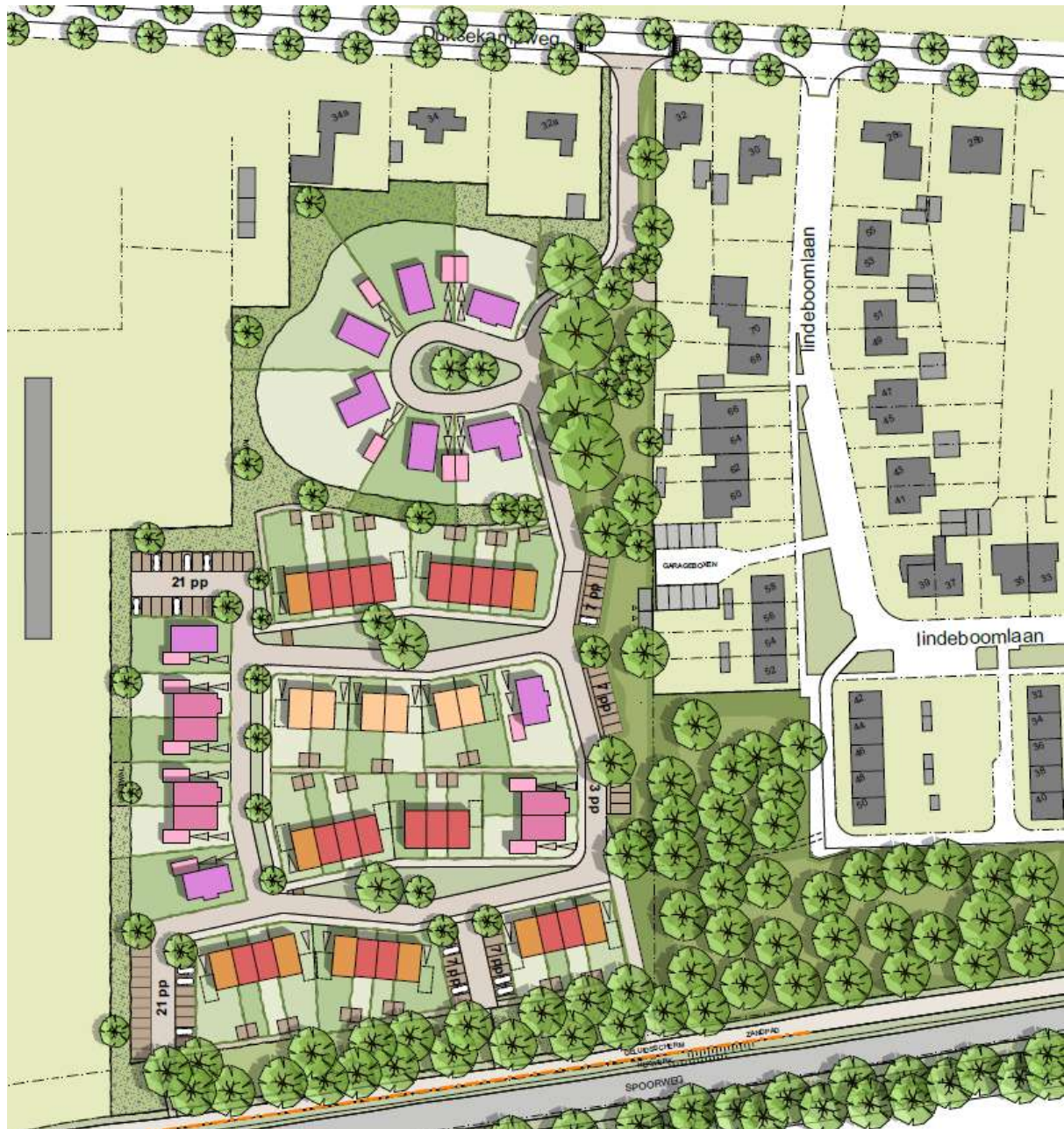
Uiteindelijk stedenbouwkundig plan uit januari 2023, aangepast naar aanleiding van zienswijzen. Aanpassing betreft de het iets naar het zuiden verschuiven van de noordelijke ontsluitingsweg, zodat boom 3 (noordelijke eik) behouden kan blijven (bron: Weusten Liedenbaum Architecten)
