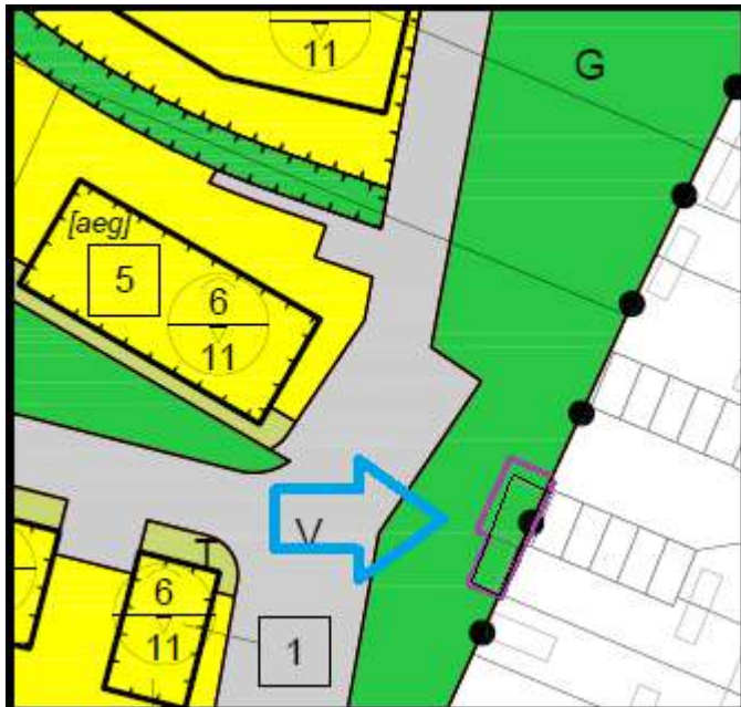
Afbeelding: uitsnede uit verbeelding ontwerpbestemmingsplan. Het paarse gedeelte krijgt nu de bestemming 'Bedrijf - Nutsvoorziening'. Met de dunne zwarte lijn is indicatief het bouwvlak daarbinnen aangegeven.
