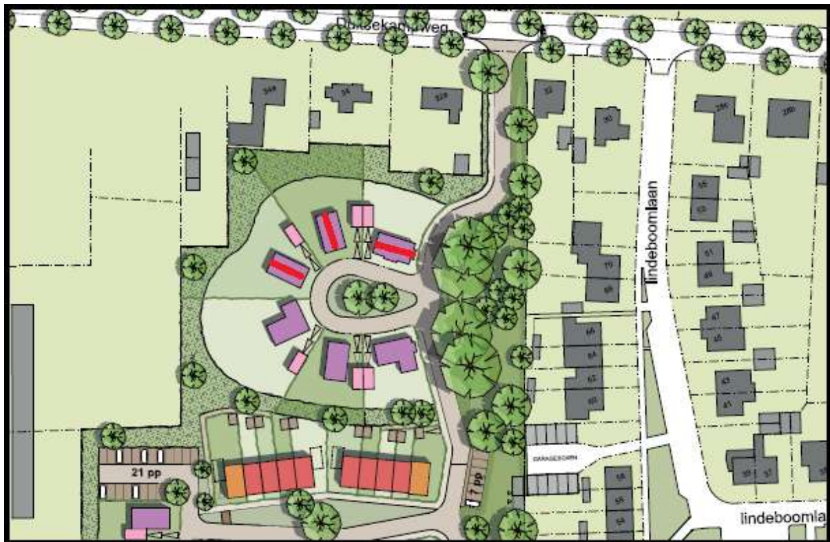
Afbeelding: uitsnede uit stedenbouwkundigplan Boven Heide, zoals deze o.a. is opgenomen in het ontwerpbestemmingsplan. Met een rode lijn is daarin de nok(hoogte) van de woningen aangegeven.
