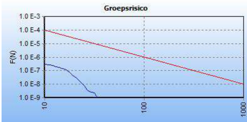
5.4 Figuur 5.4 FN curve voor 5068_leiding-N-568-30-deel-1 van N.V. Nederlandse Gasunie voor de kilometer tussen stationing 1120.00 en stationing 2120.00
