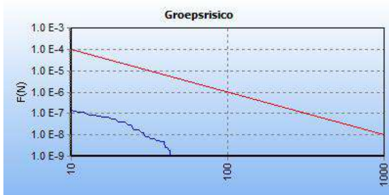
Figuur 2.9: fN-curve buisleiding N-568-10-deel-1, na planrealisatie
