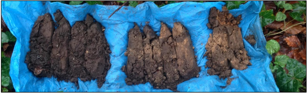
Boring 7: 0-120 cm -Mv. Boring meermaals gestaakt in grind- of wortellaag.
