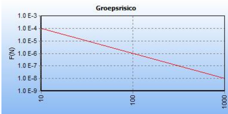
5.3 Figuur 5.3 FN curve voor 6879_leiding-N-568-14-deel-1 van N.V. Nederlandse Gasunie voor de kilometer tussen stationing 0.00 en stationing 1000.00
