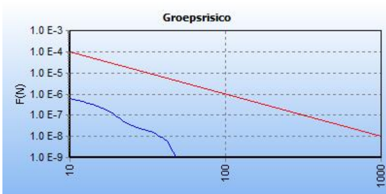
5.2 Figuur 5.2 FN curve voor 6879_leiding-N-568-10-deel-1 van N.V. Nederlandse Gasunie voor de kilometer tussen stationing 1960.00 en stationing 2960.00
