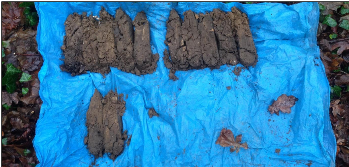
Boring 6: 0-120 cm -Mv. Meermaals gestaakt in grindlaag aan onderzijde verstoringspakket.
