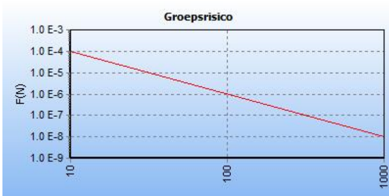
5.2 Figuur 5.2 FN curve voor 6879_leiding-N-568-10-deel-1 van N.V. Nederlandse Gasunie voor de kilometer tussen stationing 1960.00 en stationing 2960.00
